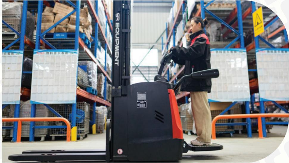
Disponen de un sistema de elevación mediante un motor eléctrico, ayudando a la reducción de tiempos y mejorando la productividad de la operación. Versatilidad y seguridad en cada movimiento. Equipados con una batería de 48 voltios y/o baterías de iones de litio, también denominada batería Li-Ion.
