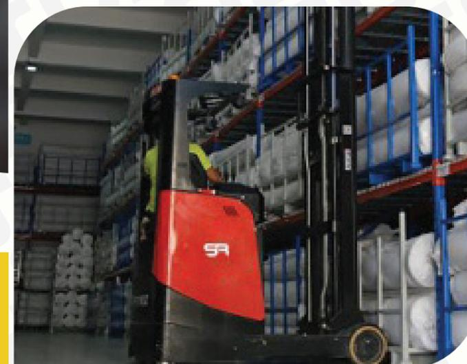
Estos equipos están diseñados para traslado y apilamiento de mercadería en diferentes sistemas de almacenamiento. Incluye una batería de 48 voltios y/o baterías de iones de litio, también denominada batería Li-Ion. Puede alcanzar a elevar 12 metros, opcional con bloqueo y programador de altura.
